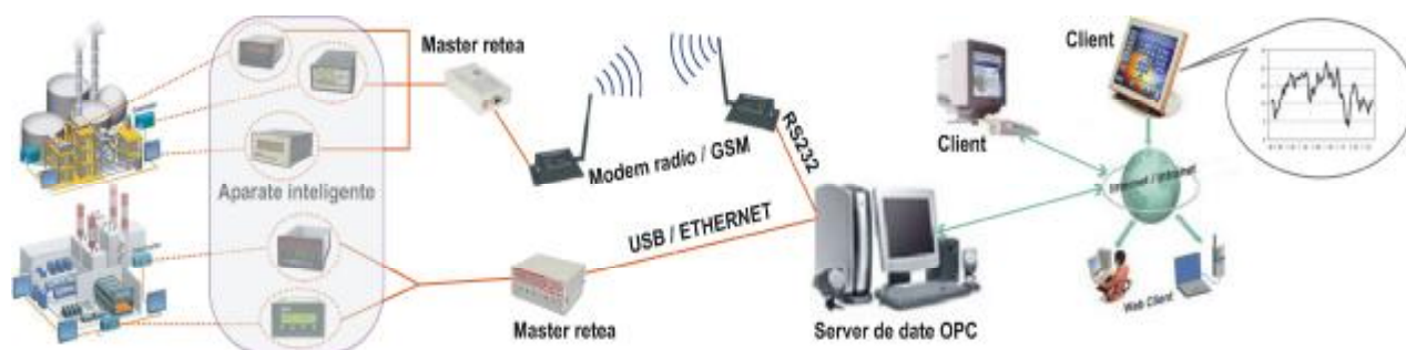
Figura 1 Aplicație hard/soft pentru monitorizarea proceselor industriale
